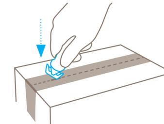
Usted utiliza las **esquinas planas** en la parte superior del cabezal de la hoja como ayuda para perforar el cartón/la cinta adhesiva.
