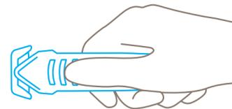
Para el mejor agarre posible, coloque el pulgar sobre **la superficie estriada**
